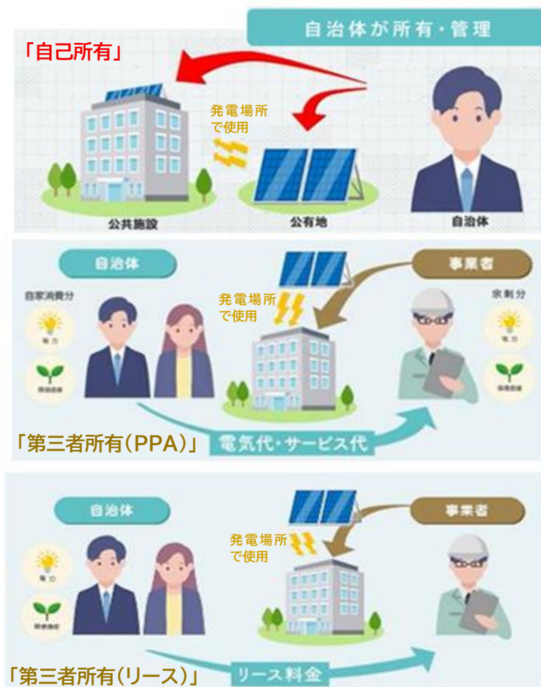
図 6-8 自家消費型の太陽光発電設備の導入パターン
