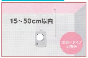
天井から15~50cm以内に火災警報器の中心がくるように 取り付けます。 ※町では、平成21年11月に各家庭に住宅用 火災警報器を配布しています。まだ設置 されていない方は設置をお願いします。
