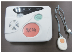
緊急通報装置
