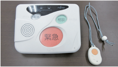
緊急通報装置
