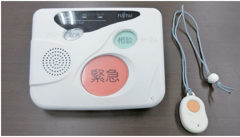
緊急通報装置
